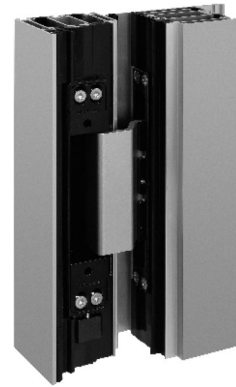
Verdeckt liegendes Türband, dreidimensional einstellbar, max. Öffnungswinkel 100°,
